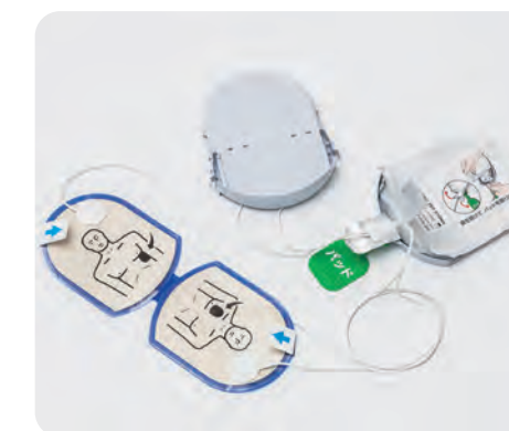
除細動パッドとバッテリーを一体化した除細動パッドバックを採用。除細動パッドは、有効期間が長寿命になりました(除細動パッドバックは開封後交換が必要です)。
