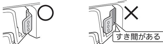
ツメが上図「O」のようにロックされているときは、パッドパックは正しく接続されています。
